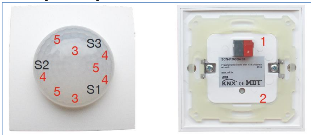
Abbildung 3: Aufbau und Anordnung der Sensoren/Leuchtdioden – SCN-P/G360x3.03
