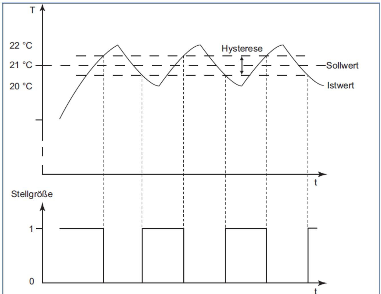
Der 2-Punkt Regler ist in seiner Wirkweise der einfachste der 3 auswählbaren Regler. Er kann die Stellgröße nur EIN oder AUS schalten. Der Zweipunktregler zählt zu der Klassifizierung der unstetigen Regler.
