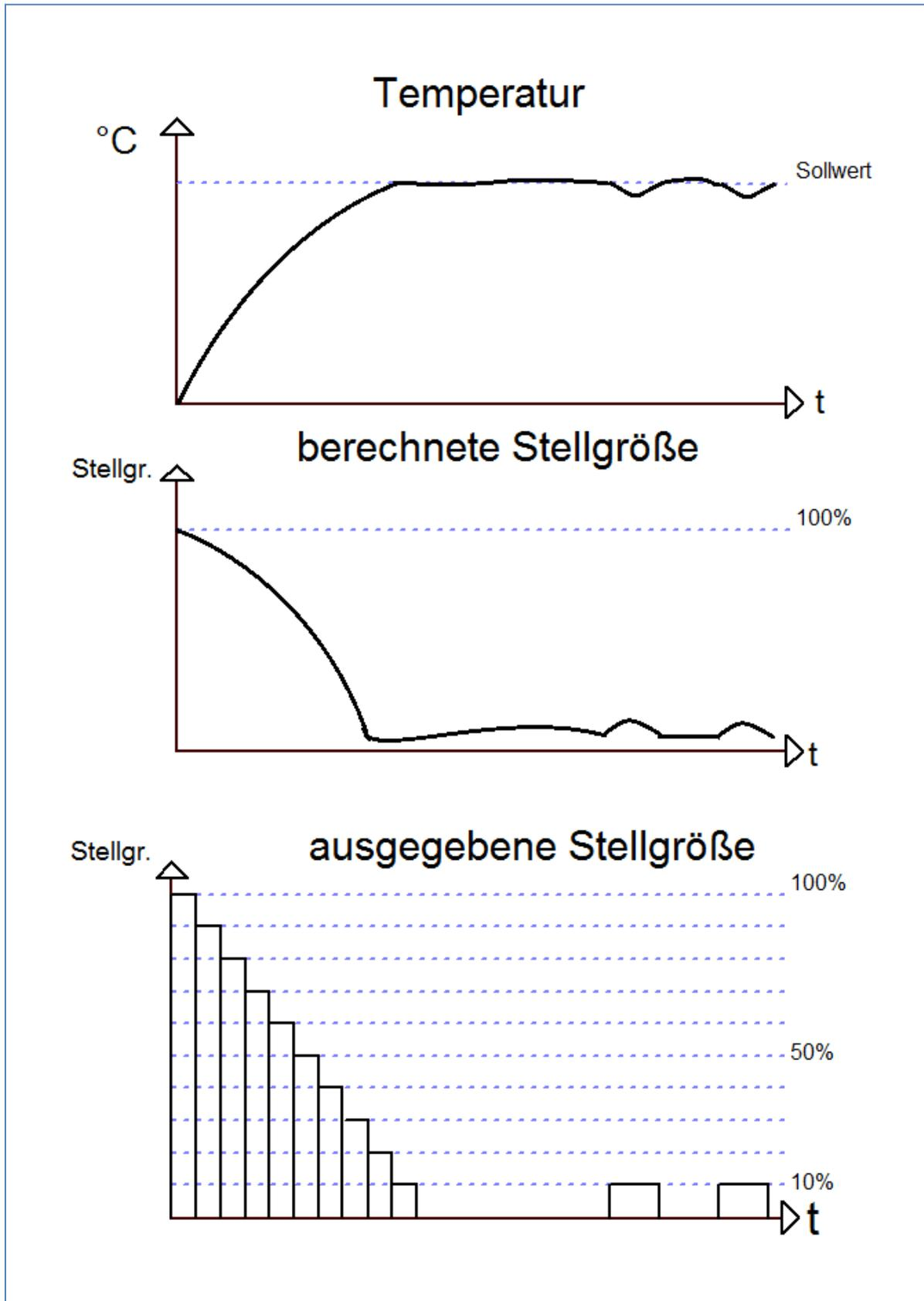
Die stetige PI-Regelung ist eine Regelung mit einer sich ständig ändernde Stellgröße. Der Wert für die Stellgröße wird dabei immer punktgenau an die anstehende Regeldifferenz(damit wird der Unterschied zwischen Sollwert und Isttemperatur bezeichnet) angepasst. Die PI-Regelung besteht dabei aus einem proportionalen Anteil, dem P-Regler, und einem integralen Anteil, dem I-Regler. Durch die Zusammenschaltung dieser beiden Regler Typen werden die Vorteile beider Regler kombiniert.
